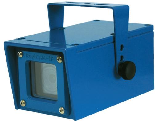
**La MTL RugiCAM-IP est une caméra réseau à sécurité intrinsèque (SI)** appropriée pour le montage en Zone 0 / Zone 20. Elle peut être connectée directement au système Ethernet SI compatible via le câble Cat5e ou le Wi-Fi optionnel. Son design compact, robuste et rentable en font le choix idéal pour de nombreuses applications :
